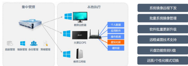
图五 锐捷云大屏 IDV 技术架构
