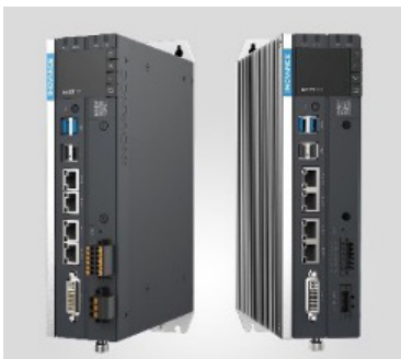
图2 汇川 AC800 系列高性能智能机械控制器
